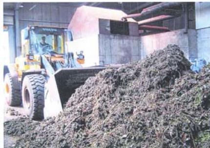
Der angelieferte Bioabfall wird vor der Kompostierung zusammengeschoben. Daniel Rogall steuert den Radlader. Foto: M. Thormählen
